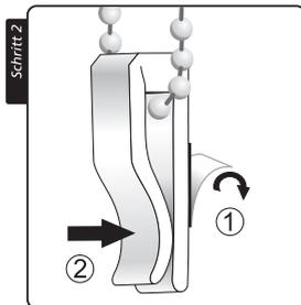
Entfernen Sie nun die Schutzfolie vom doppelseitigen Klebeband (1) und befestigen Sie den Kettenhalter an gewünschter Position mit dem Klebestreifen am Fensterrahmen. (2)
