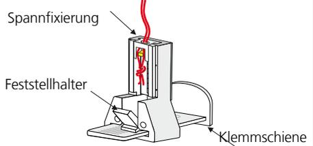
Leichte Spannung durch die Fixierung aufbauen und einrasten lassen.
