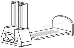
Untere Klemmschienen in Spannhalterung einführen und auf dem Fensterflügel unten leicht einklemmen, ebenfalls noch nicht fest fixieren.
