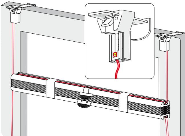
Die Spannfixierung für die oberen Halter ist vormontiert.
