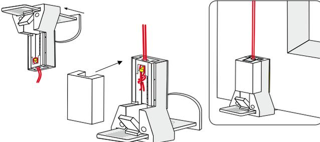
Klebestreifen vom Klemmträger oben entfernen und den Träger durch Einrasten der Klemmschiene und festen Druck am Fensterrahmen fixieren. Danach ebenso mit den Klemmträgern unten verfahren. Nach fertiger Montage allen Klemmträgern die Abdeckhaube aufstecken.
