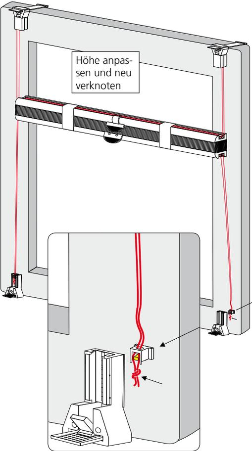
Länge der unteren Spannschnüre der Fenstergröße anpassen, ggf. kürzen und mit neuem Knoten in der Spannfixierung fixieren. Spannfixierung für die unteren Halter vorsichtig in die Halterungen einführen.
